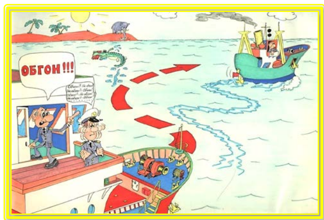
Ситуации обгона судна: суда В и С обгоняющие, судно D – пересекающее курс судна А
