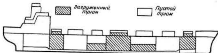
Рис. 4.6. Схема чередующейся загрузки трюмов на балкере
