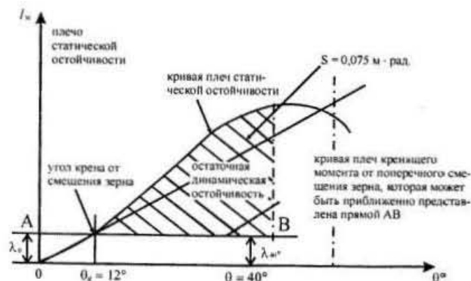
Рис. 4.9. Диаграмма статической остойчивости судна, перевозящего зерно навалом
